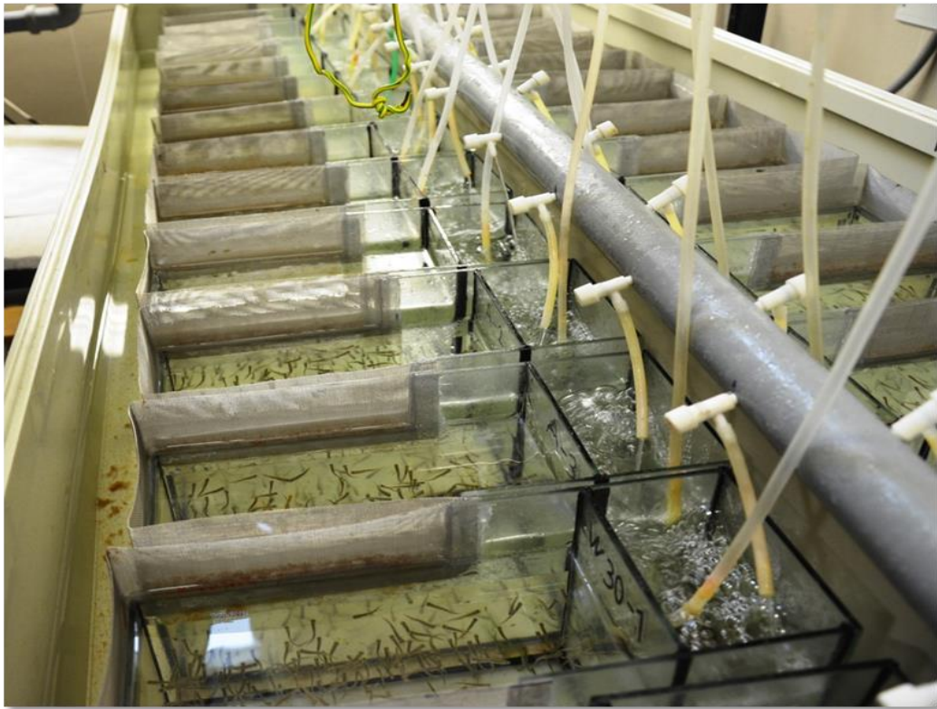
Obr. 12. Akvária s obsádkou larev síha během testování vlivu délky co-feedingu a načasování převodu.
